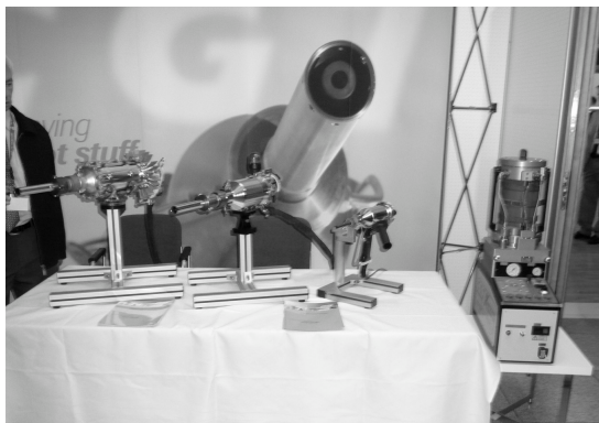
図3 ドイツCGT社の最新のコールドスプレー装置KINETIKS 8000を含むシリーズ(右からKINETIKS2000(携帯型), 40000, 8000)最新の8000は、最高ガス温度1000℃にまで達する。
