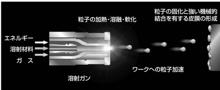
図3.1-1 溶射の原理
